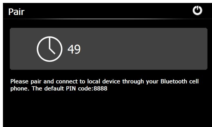
U meniju mobitela izaberite "Traženje zvučnog signala" ili neki sličan meni. Kada mobitel pronađe uređaj, pojavljuje se naziv uređaja (npr. PND), tada izaberite meni „Povezivanje“ i upišite PIN kod, koji je tvornički podešen na 8888. Nakon povezivanja, pojaviće se sledeći ekran sa stanjem povezivanja i nazivom mobitela.
